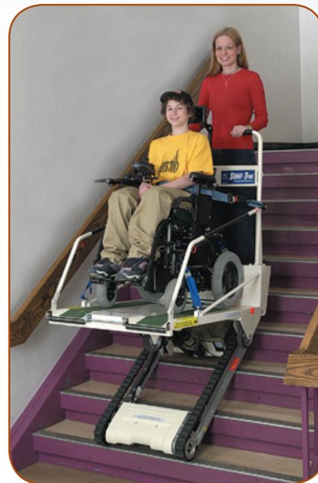
El Super-Trac es fácil de usar. Como se muestra en esta secuencia, un operador puede transportar fácilmente una pesada silla motorizada y su pasajero. La foto arriba muestra al pasajero sobre la plataforma, a la cual llegó a través de la rampa incorporada. La silla es sujeta mediante los retenes ajustables y un cinturón con bloqueador eléctrico proporciona seguridad adicional al pasajero.
